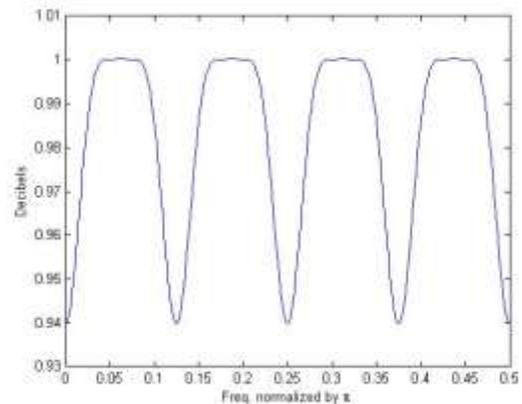
Fig.2 (d) Magnitude response of Amplitude distortion function
