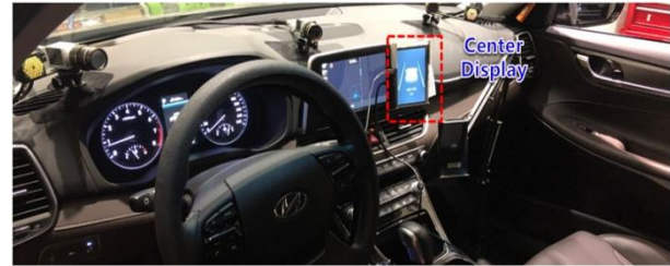
Fig. 2. The visual alarm
