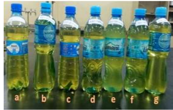
Fig. 4 Test samples (a) B20; (b) B20 + G25 ppm; (c) B20 + G50 ppm, (d) B20 + G100 ppm; (e) B20 + G025 ppm; (f) B20+G050 ppm; (g) B20 + G0100ppm
