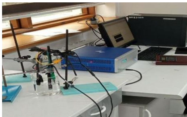
Fig. 2 CS-350 corrosion test device
